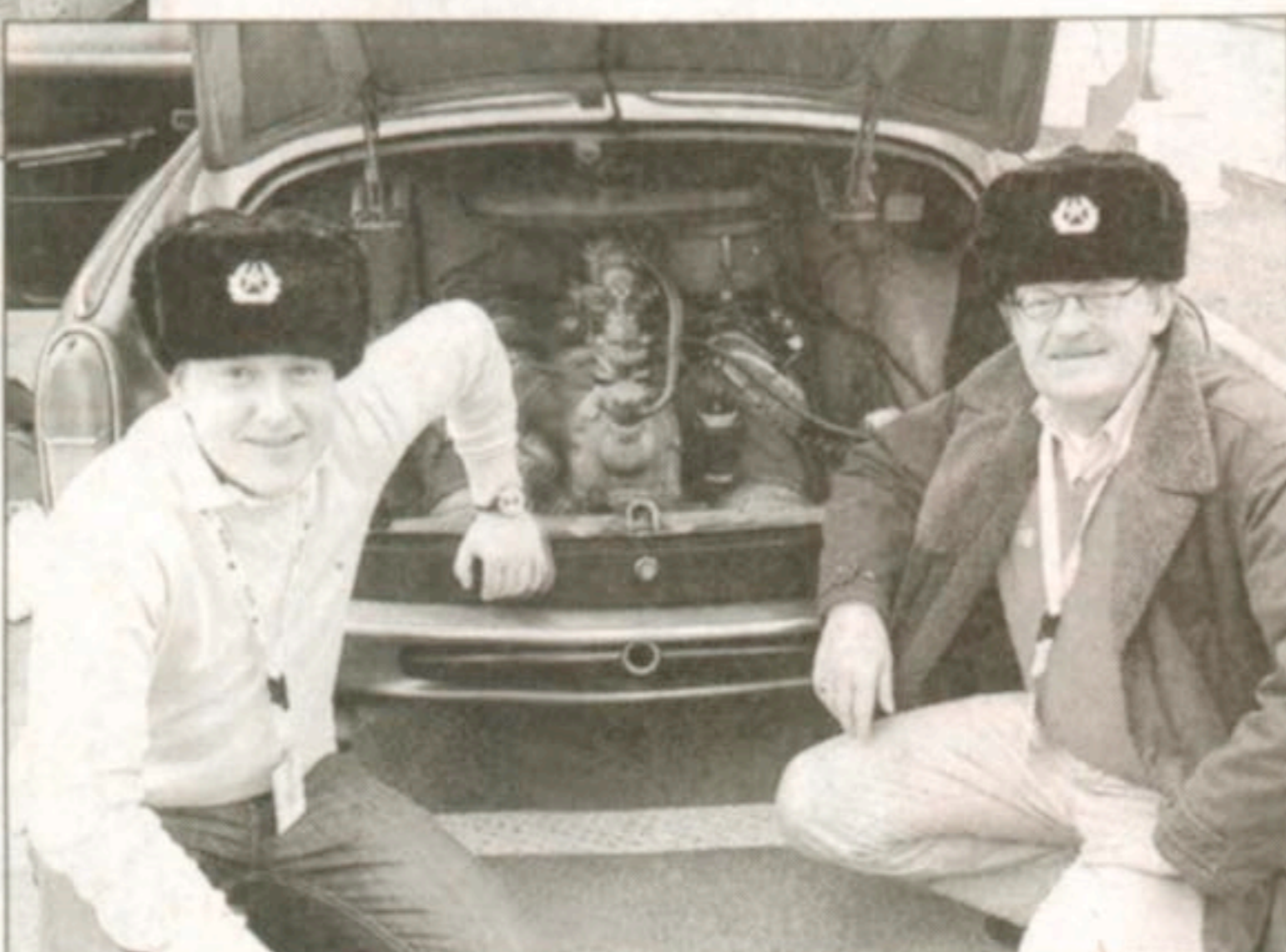
■ Acht luchtgekoelde cilinders in de achterbak van de Tatra 603 uit 1964 van vastgoedman Jos Leemmens en zijn zoon Patrick .
